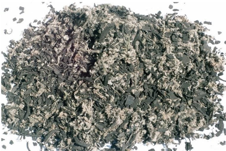
Für die Thermolyse ist ein Gemisch aus Überfraktion/Textile und Gummigranulat absolut ausreichend.
