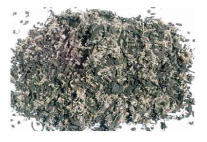
Für die Thermolyse ist eine Gemisch aus Überfraktion/Textile und Gummigranulat absolut ausreichend.
